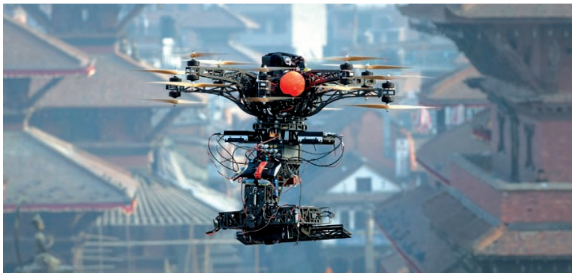
Für 3D-Aufnahmen aus ungewöhnlichen Blickwinkeln sorgt die Montage der 3D-Kamera »SinaCAM« an einen Multikopter, der Lasten bis zu 6 kg tragen kann. »SinaCAM« ist ein Projekt des Nürnberger Entwicklungsdienstleisters Solectrix. (Foto: Philipp Weber, www.cagefish.com) Seite 10
